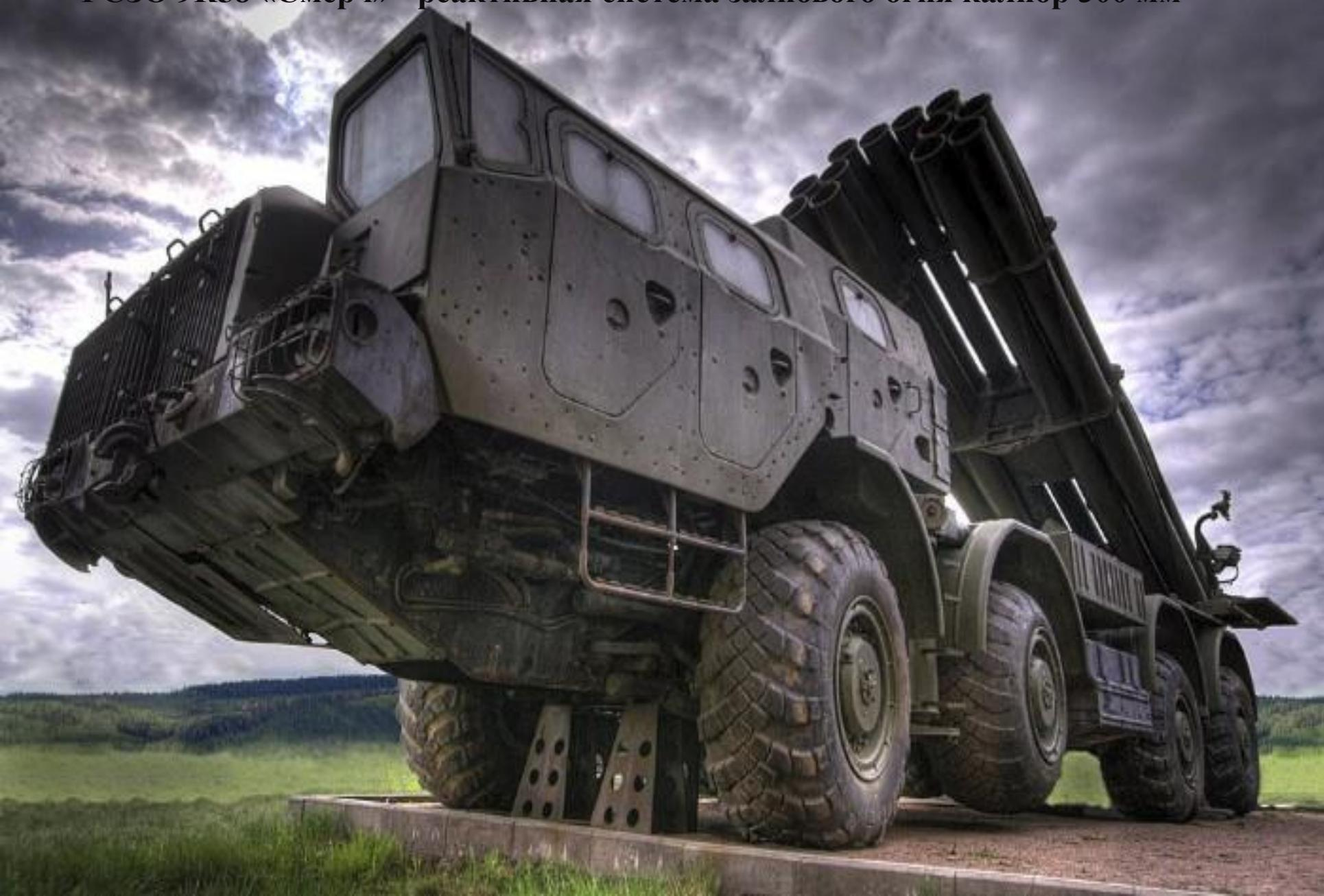
**БМ-21 «Град» (9К51) – реактивная система залпового огня калибр 122 мм**
